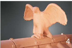
Die Position des Adlers auf dem First ist frei wählbar. Es ist möglich, den Adler auch auf zwei Firstziegel zu montieren. Falls der Firstziegel einen kleineren Radius als die Passfläche des Adlers aufweist, wird zur seitlichen Stabilisierung empfohlen, den Spalt mit Mörtel aufzufüllen.
